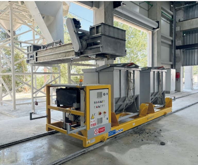
Carrello trasporto benne calcestruzzo a batteria
