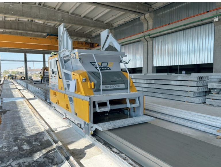
Estrusore EVO2 durante la fase di getto
