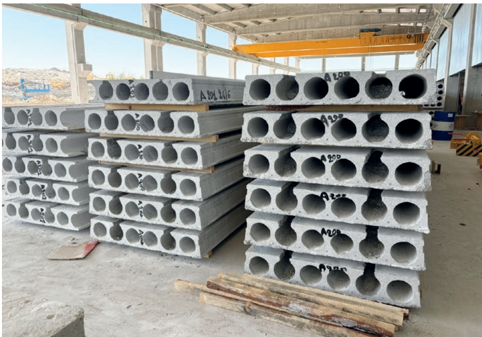
Pannelli alveolari nello stoccaggio pronti per la consegna in cantiere
