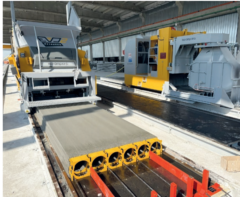
Utilizzo delle piastre di partenza ad inizio pista per ridurre lo sfido (start plate)
